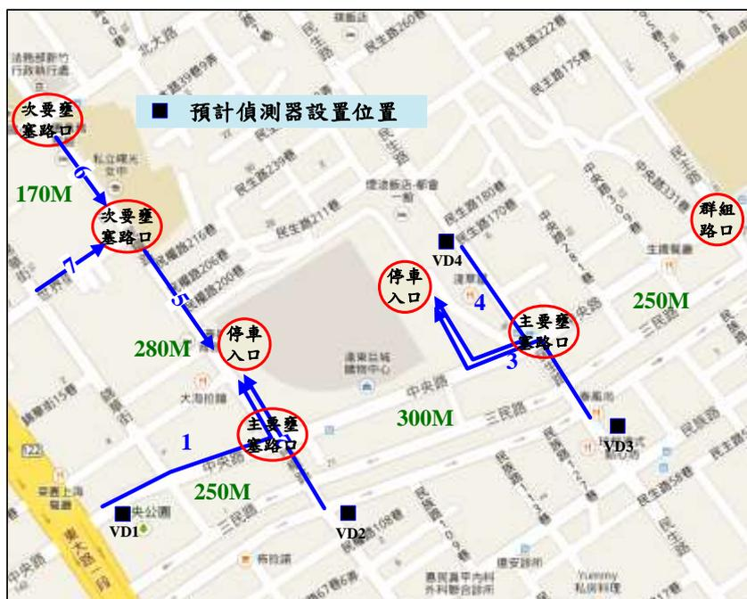
圖 2-3 中央路動態時段號誌控制策略路側設備預計佈設示意圖
